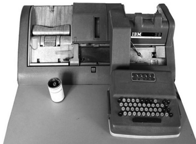
**Figura 13.** La perforatrice di schede IBM 026.
