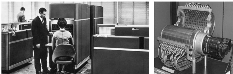
**Figura 12.** La IBM 650 in una installazione americana del 1961 e una memoria a tamburo di quei tempi; ruotava a 12.500 giri al minuto ed il tempo di accesso era di 4,8 ms.
