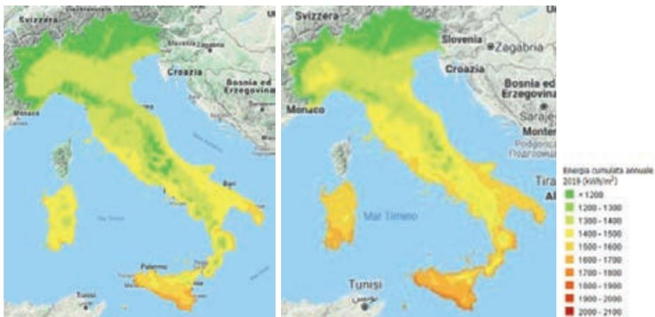
Fig. 7. Mappa italiana della radiazione solare nel 2018 (a sinistra) e nel 2019 (a destra). La radiazione solare al suolo cumulata del 2019 è più elevata di quella osservata nel 2018. (Fonte: Solare fotovoltaico, GSE 2020; Elaborazione a cura di RSE su dati EUMETSAT, <http://sunrise.rse-web.it/>).
