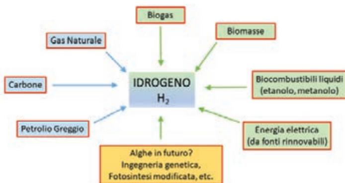
Fig. 1. Potenziali fonti di produzione dell'idrogeno: Oggi industrialmente si utilizzano solo le tecnologie di produzione da gas naturale, carbone, petrolio e da elettrolisi.
