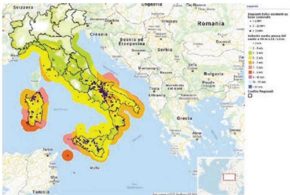
Fig. 5. Mappa eolica dell'Italia, velocità media del vento a quota  $H = 50$  m sul livello topografico. Elaborazioni RSE consultabili liberamente (<http://atlanteeolico.rse-web.it/>).
