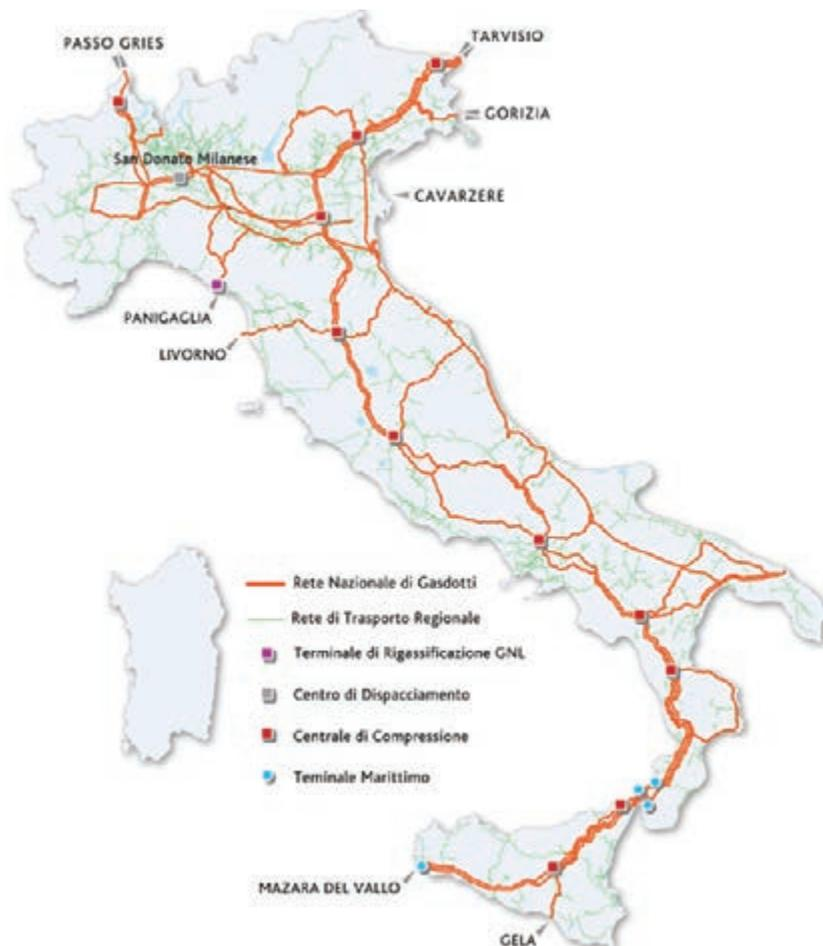
Fig. 2. Rete di metanodotti per il trasporto primario. Si notano gli otto punti di entrata nella rete di importazione gas italiana, cui si è aggiunto un nono punto il primo gennaio 2021, il gasdotto TAP, che trasporta il gas proveniente dall’Azerbaijan. Il punto di approdo sul territorio nazionale è a Melendugno, sulla costa salentina in provincia di Lecce.
