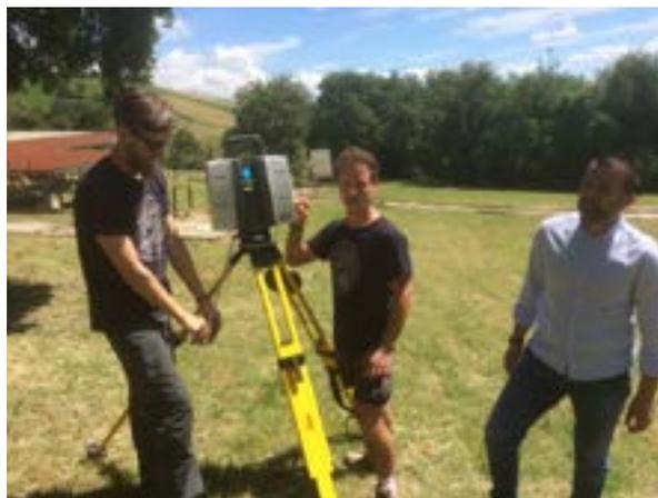
Fig. 58. Una fase del rilievo topografico dello stato attuale dell'area archeologica con laser scanner.
