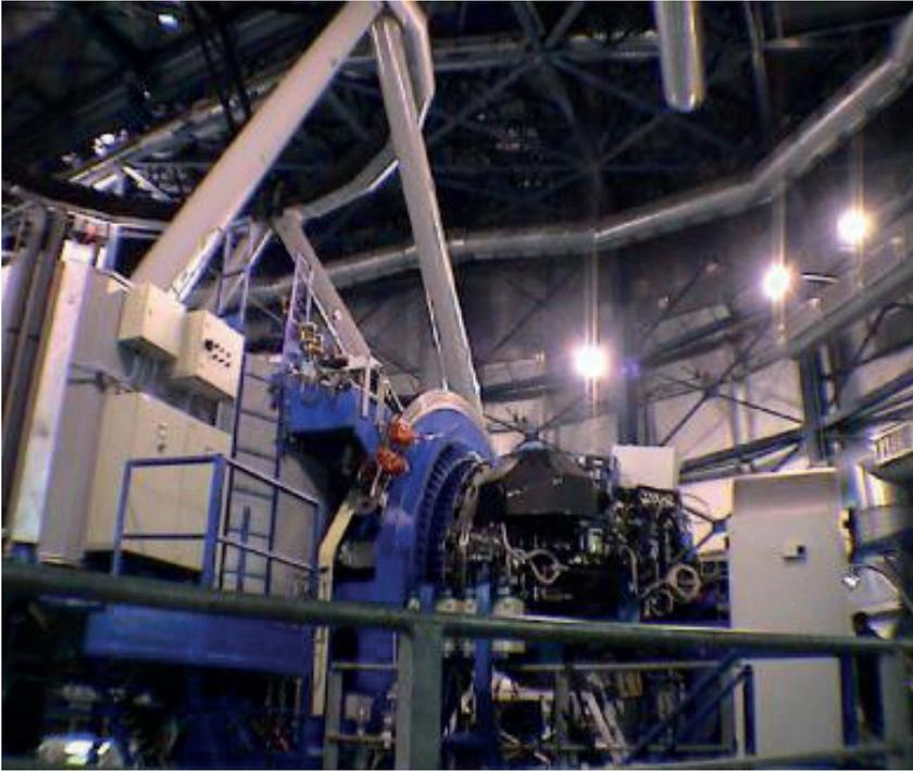
**Figura 9.2** Lo spettrografo VIMOS montato sul fuoco Nasmyth del telescopio UT3 Melipal del VLT. Crediti per la foto European Southern Observatory ESO/G. Sciarretta.
