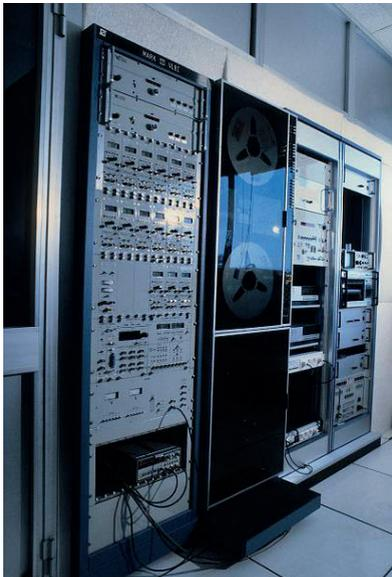
**Figura 5.4** Il terminale VLBI MKIII della stazione di Medicina. A sinistra i dispositivi per la conversione della frequenza di osservazione alla media frequenza, i 14 Base Band Converters, e l’apparato che predispose il segnale prima di essere inviato al registratore a nastro magnetico sulla destra. Crediti: INAF-IRA.
